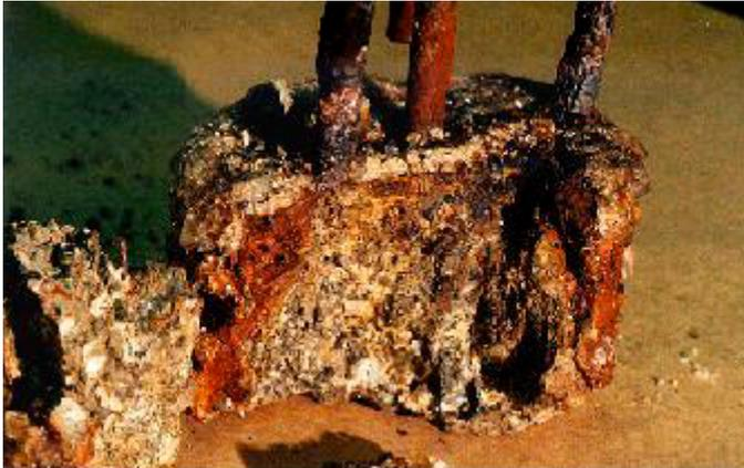
Die Sichtprüfung der beiden Betonelemente, die in Hocking County, Ohio, gemäss den OHIO DOT Spezifikationen entwickelt und geschüttet wurden, hat eindeutig ergeben, dass ungeschützter Beton unter Einwirkung von Spüllaugen schnell verwittert (siehe Abbildung 6). Diese Beobachtung wird durch die Analyse der für den Test verwendeten Lauge unterstützt. In der Lauge der Kontrollprobe wurden signifikante Konzentrationen der elementaren Betonbestandteile in Lösung nachgewiesen.
